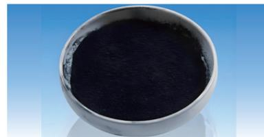
▶ 高能量密度锂离子电池用硅基负极材料 ◀
